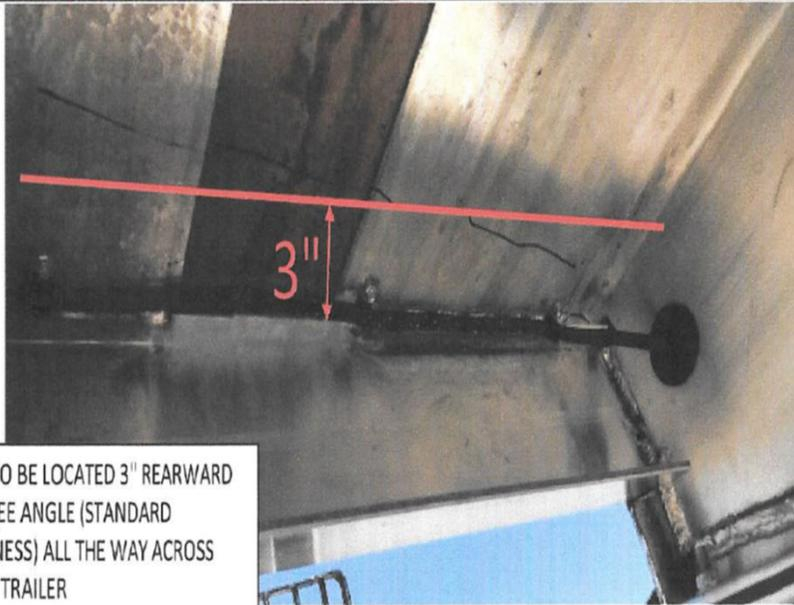
WIRING HARNESS TO BE LOCATED 3" REARWARD OF INSIDE 90 DEGREE ANGLE (STANDARD LOCATION OF HARNESS) ALL THE WAY ACROSS THE FRONT OF THE TRAILER
